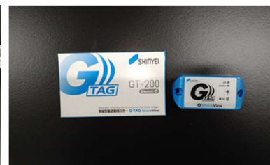
輸送衝撃測定のための 加速度センサ
